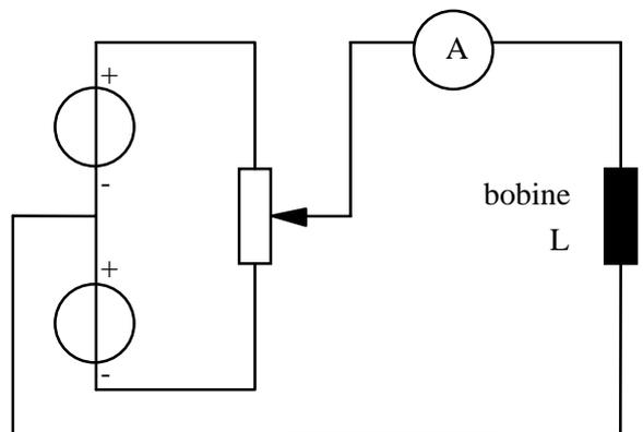
La bobine est constituée de 150 spires de fil de cuivre, bobinées autour d'un noyau magnétique d'une longueur  $l$  de 15 [cm] et sa résistance ohmique vaut 25 [ $\Omega$ ] . Le noyau a été choisi dans la catégorie des matériaux magnétique (voir introduction de ce chapitre).
