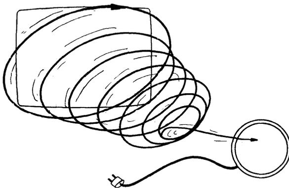
Cette façon de faire est utilisée pour démagnétiser les tubes image des téléviseurs couleur. En effet, le balayage de l'écran par le faisceau d'électrons est commandé par un champ magnétique. Si ce champ vient à être perturbé par l'aimantation rémanente d'une pièce métallique, l'image va perdre de sa qualité les couleurs seront faussées.
