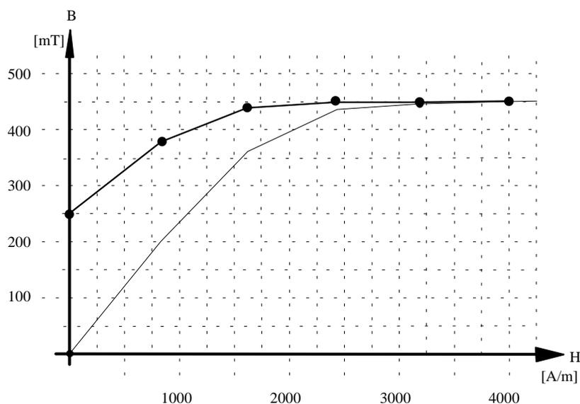
Le point constitué du champ d'induction magnétique  $B$  et de l'axe des  $y$ , représentant l'induction rémanente  $B_r$ , pour une intensité du champ magnétique  $H$  à la valeur 0.
