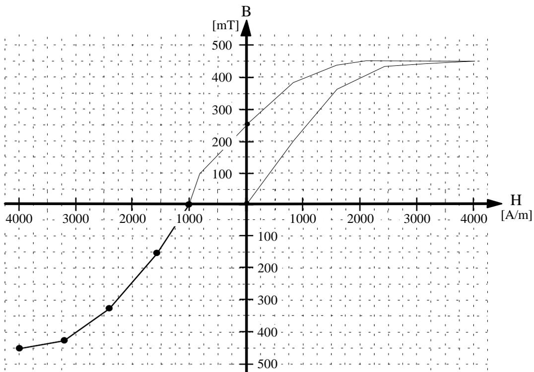
Nous parlerons de SATURATION, au moment où l'augmentation de l'intensité du champ magnétique  $H$  ne modifie plus le champ d'induction magnétique  $B$ .
