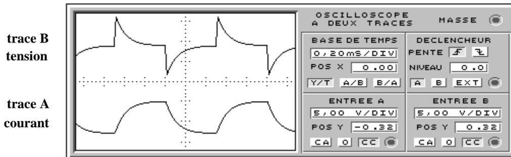
Nous constatons que la représentation du courant et de la tension ont un sens opposé. Il s'agit de l'effet de self induction.
