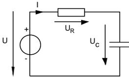
Il est simple de constater que lorsque le condensateur sera complètement chargé, il n'y aura plus de chute de tension aux bornes de la résistance. Cela signifie que la valeur du courant sera tombée à zéro.
