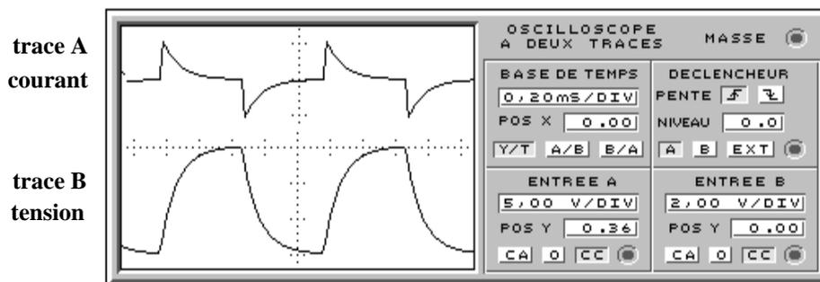
L'oscilloscope ci-contre nous montre la forme du courant et de la tension sur un condensateur lors de charges et décharges successives en tension continue.
