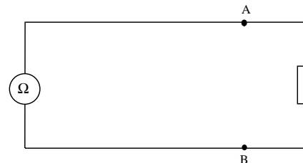
Schéma électrique équivalent obtenu par lecture du cadran de l'ohmmètre.
