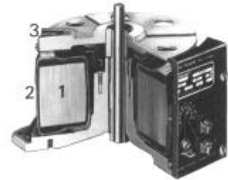
Vue en coupe d'un autotransformateur variable montrant (1) noyau de fer toroidal; (2) enroulement; (3) balai mobile. (American Superior)
